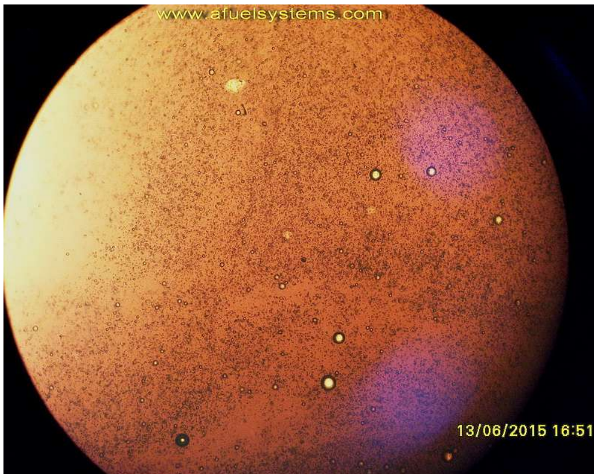
Сверху - мазут М-100 исходный, Снизу - мазут М-100 гомогенизированный на TRGA-10. Образцы 2009 года. Верхний слой. Образцы в открыты 2015 году. Разница.
