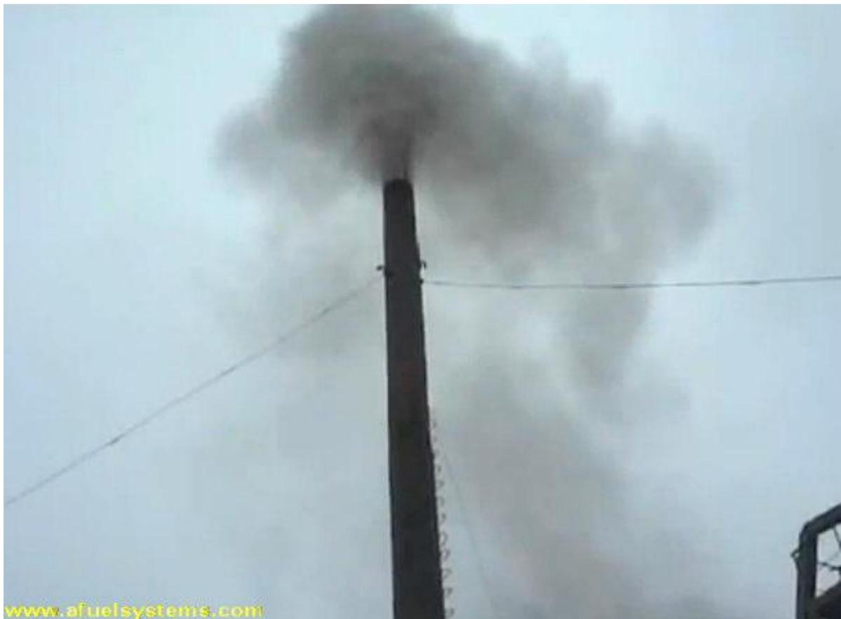
**Дым из асфальтовой печи на которой установлен и только что включен гомогенизатор TRGA.**
