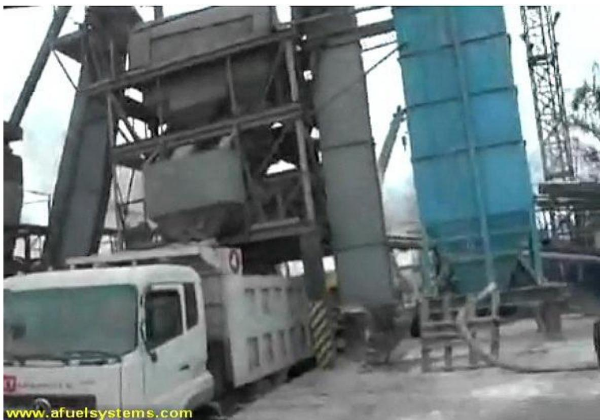
**Дым из асфальтовой печи на которой установлен и только что включен гомогенизатор TRGA.**
