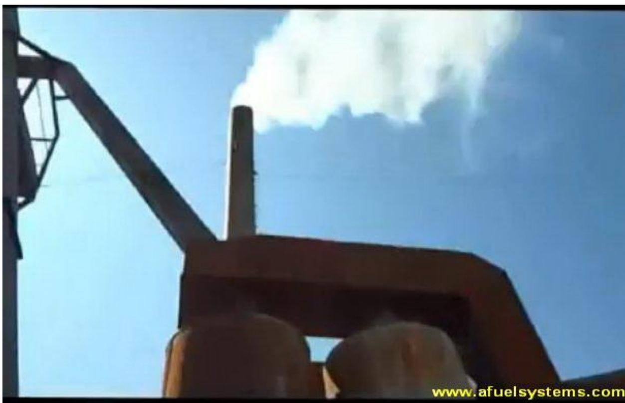
**После регулировки количества воздуха, дым из трубы стал еще светлее.
