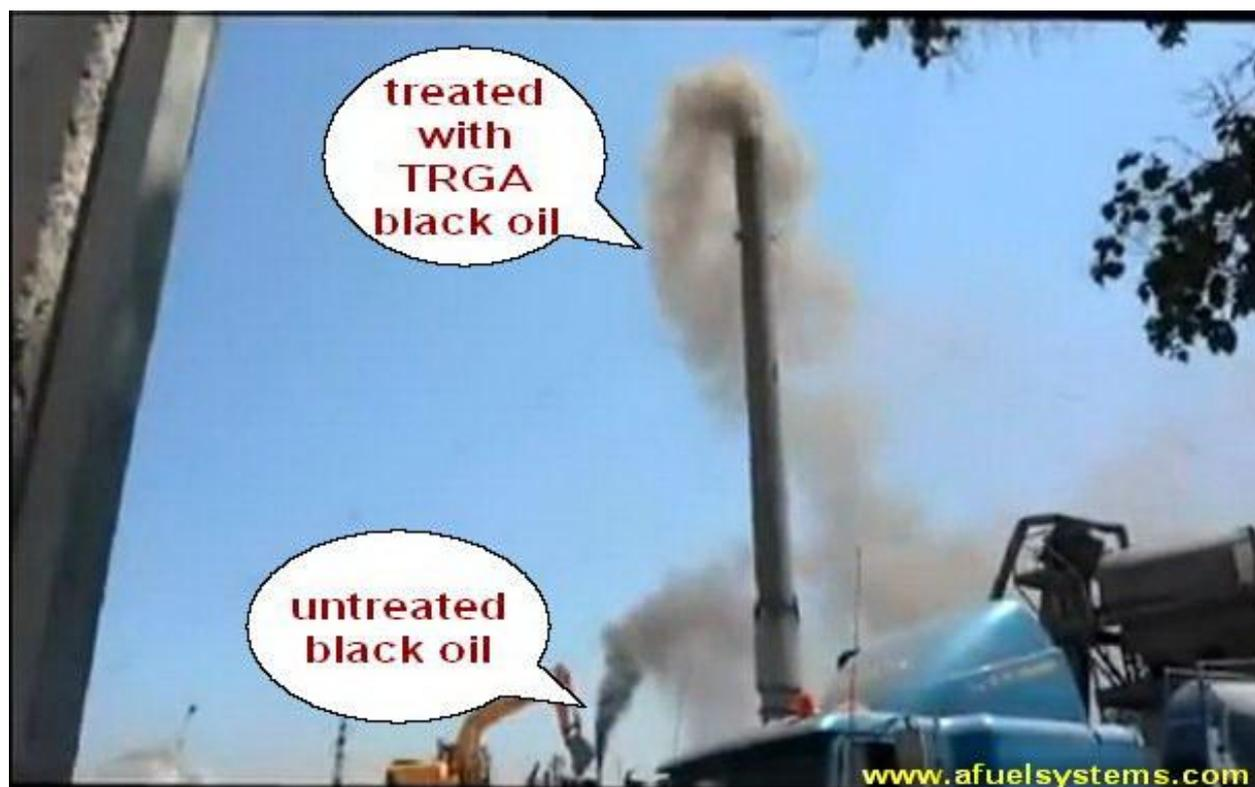
На этой печи была установлена форсунка с диаметром 4 мм. Попытка уменьшить диаметр отверстия форсунки приводила к снижению температуры в печи и нарушению технологического режима.
