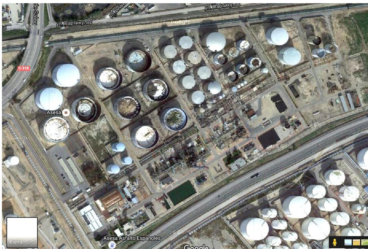
**Морской климат и морская транспортировка гарантируют обводнение мазута, скапливание тяжелых фракций, смол, асфальтенов, парафинов и конденсатной воды на дне резервуаров и необходимость периодической очистки резервуаров от накопленных разнородных углеводородных смесей и замазученной подтоварной воды.**
